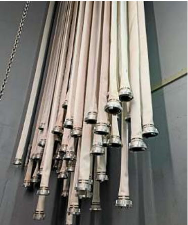
Jeder Schlauch muss nach dem Einsatz gewaschen und begutachtet werden. Dann wird er im Turm getrocknet. ANJA DEROWSKI
