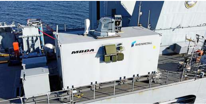
Der Laserwaffendemonstrator ist in einem Container integriert, der auf der Fregatte „Sachsen“ installiert wurde.
